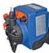
Насос-дозатор для извести с электронным управлением и нитриловыми уплотнениями 7 л/мин - 7 бар
